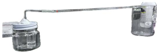
図2. 呼吸量を測定する実験装置.
